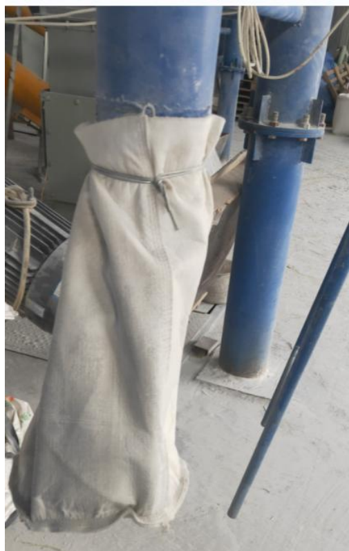
图 3-5 多层厚滤布的小布袋除尘器
