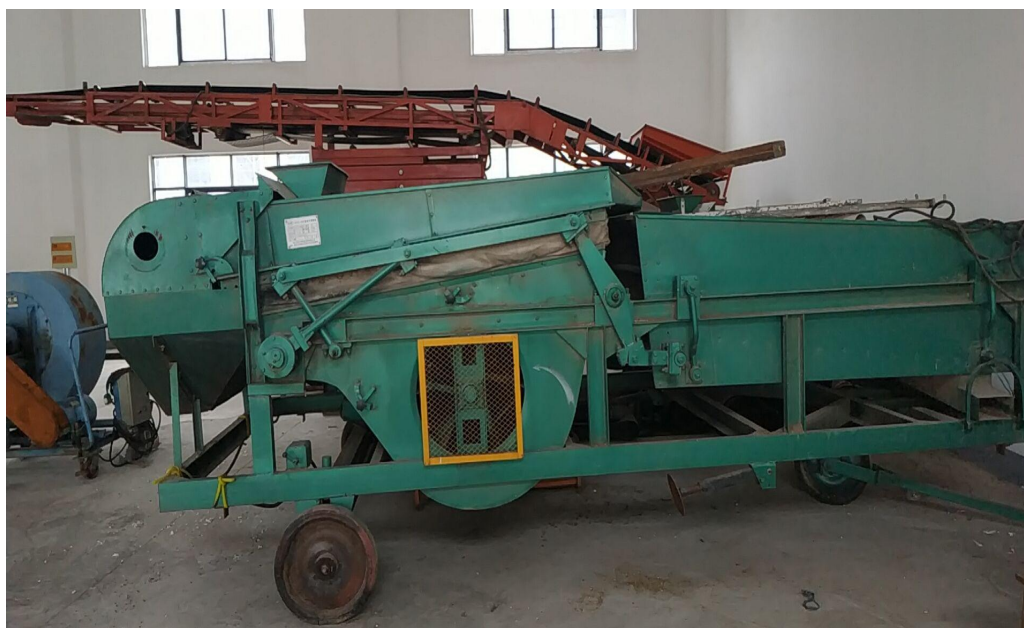
图 3-1 移动式筛分机自带布袋除尘器
